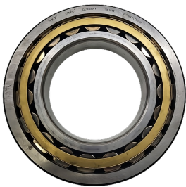
Abbildung 4: Beschädigtes Zylinderrollenlager SKF NU236 ECM
